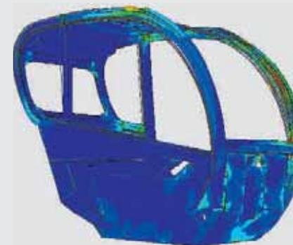
Cabina con **omologazione ROPS-FOPS** progettata con cellula di sicurezza per impedirne la deformazione in caso di ribaltamento o caduta di carichi pesanti.
